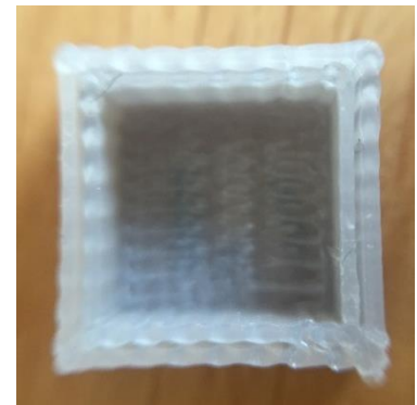
Figur 2: Resultat av for tynne vegger
