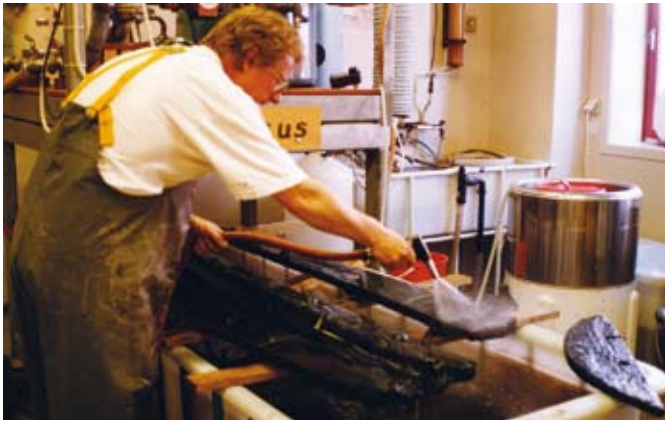
Konservering av 2000 år gamle trekonstruksjoner. Treverket vaskes før det impregneres i PEG 400/4000 og frysetørres. (Foto: Gordon Turner Walker.)
